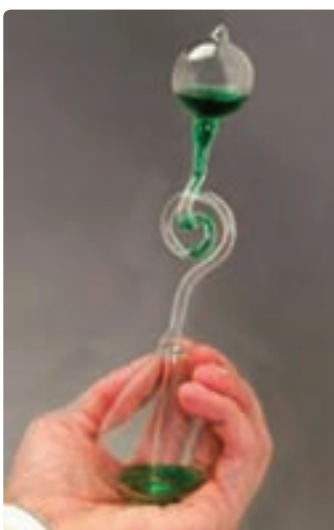
شکل ۴-۴۲ با در دست گرفتن حباب شیشه‌ای و گرم کردن آن، مایع رنگی در لوله ماریچ بالا می‌رود.
